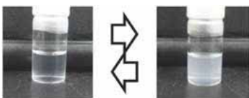
感熱応答性生分解性ホモポリマーの温度変化による溶解性変化
